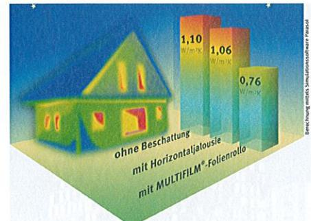
U-Wert-Verbesserung einer Wärmeschutzverglasung durch die Folienrollos von Multifilm
