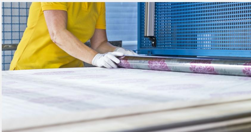
Foto 3: Zwei verschiebbare Prägetische ermöglichen effizientes Herstellen der Folien.
