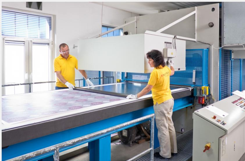
Foto 1: Flächenpräganlage eigens zur Herstellung der Dekorfolien MULTIDECOR Screen\*.
