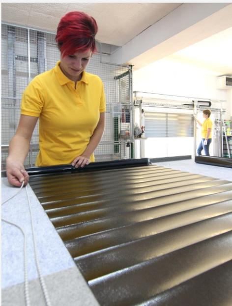
Foto 3: Aus einem breiten Baukastensystem werden Rollos auf Maß und nach Kundenwunsch gefertigt
