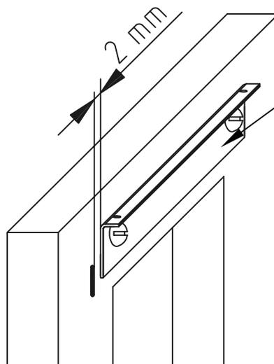
Rückblende in Waage befestigen
